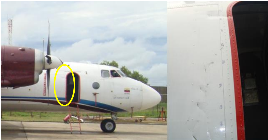
Daños en la parte trasera de la compuerta derecha a la aeronave
