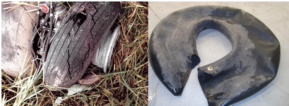
Estado final llanta interna tren principal izquierdo y neumático estallado
