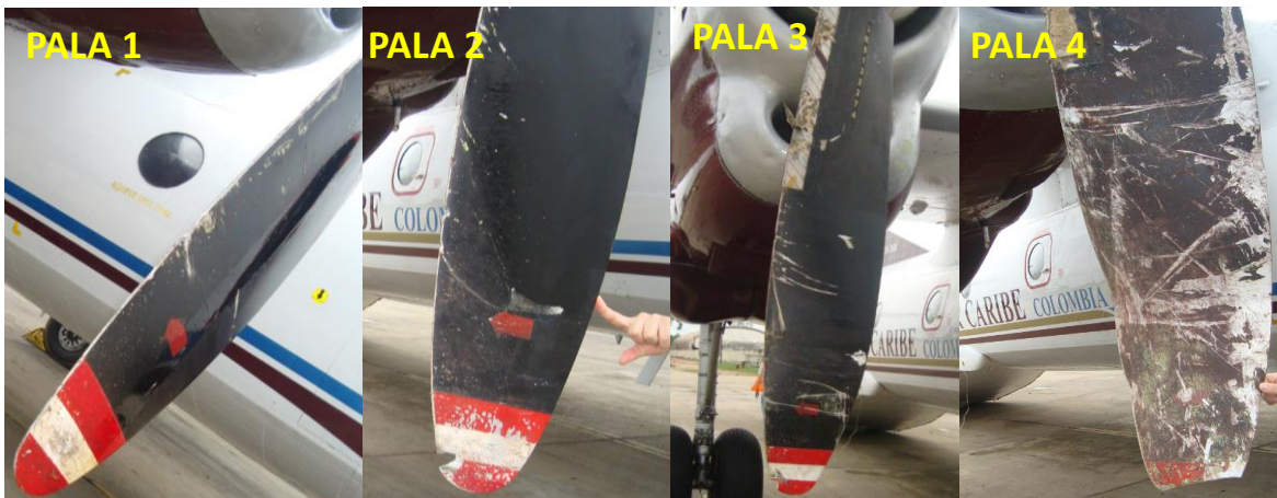
Deterioro ocasionado en cada una de las palas de la hélice del motor derecho
