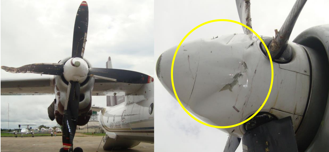
Daños en la cúpula y palas de la hélice del motor derecho HK-4728
